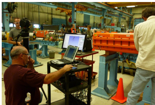
รูปที่ 2 (ซ้าย) ภาพแสดงอุปกรณ์แม่เหล็กเลี้ยวเบนของเครื่องเร่งอนุภาค Tevatron ซึ่งติดตั้งภายในอุโมงค์ใต้ดิน (ขวา) ภาพแสดงการใช้เครื่องมือ Laser tracker เพื่อวัดจุดอ้างอิงของศูนย์กลางสนามแม่เหล็กบนอุปกรณ์แม่เหล็ก
